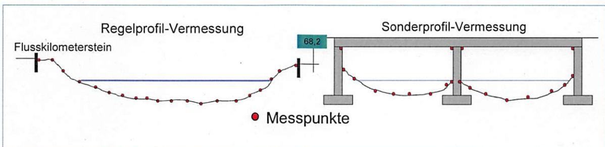
Abb. 4: Prinzip der Vermessung von Fluss- und Sonderprofilen
