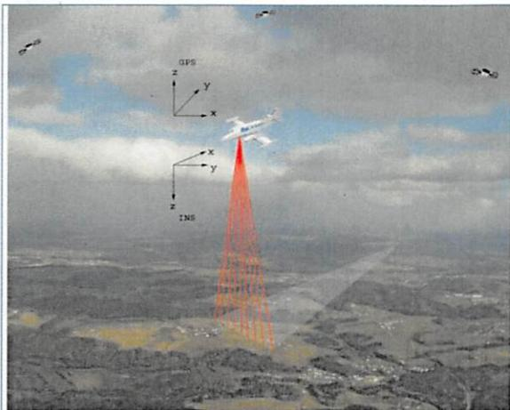
Abb. 2: Prinzip der photogrammetrischen Stereoaufnahme
